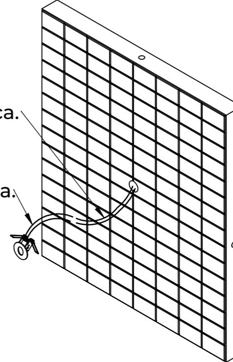
2. Conecte os cabos que saem da luminária a rede elétrica.
