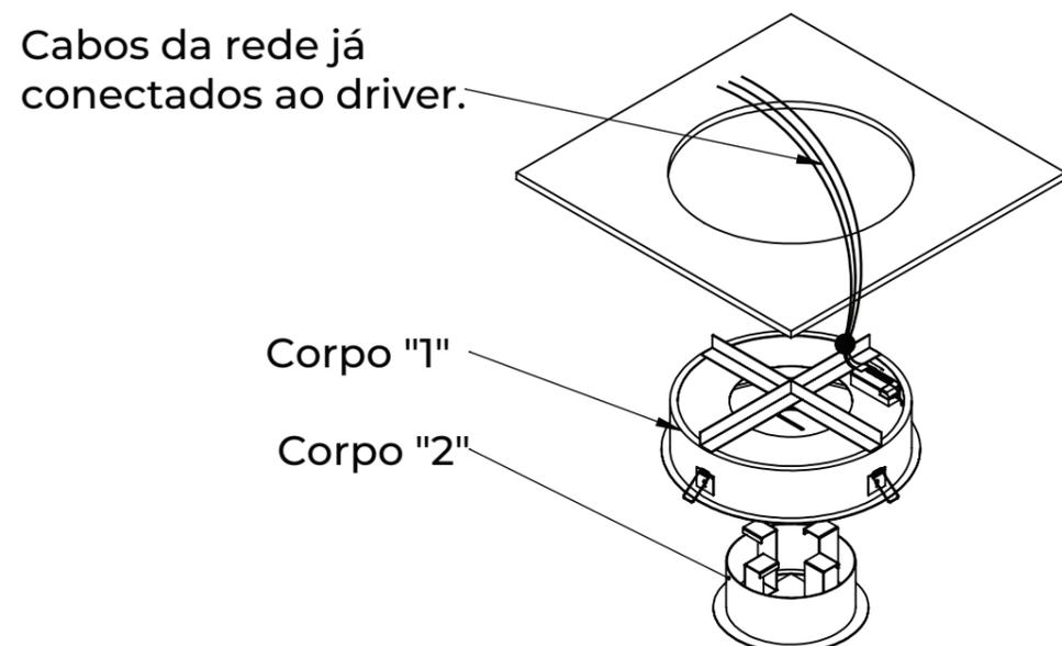
3. Suspenda o corpo "1" da luminária ajustando as molas de fixação para encaixe no nicho.
