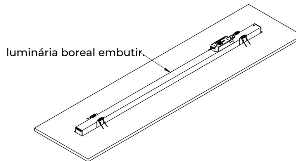
3. Suspenda a luminária ajustando as molas de fixação para encaixe no nicho. 4. luminária boreal embutir já instalada no forro.
