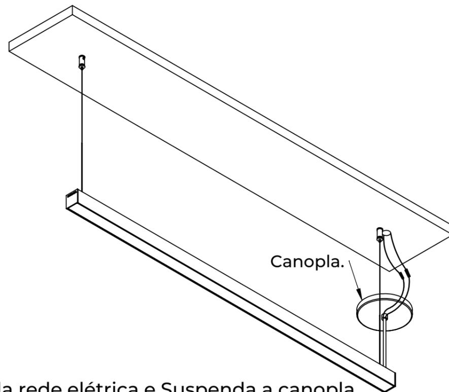
3. Conecte os cabos da rede elétrica e Suspenda a canopla.
