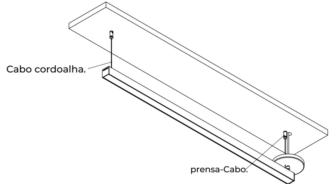
2. Suspenda a luminária e Conecte o Cabo cordoalha aos presa Cabo.
