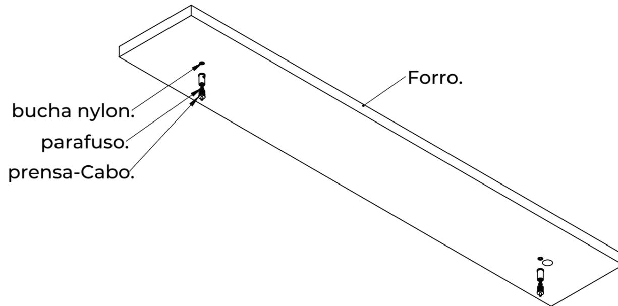
1. Fure a superfície demarcada e encaixe as buchas nylon e presa-Cabo.
