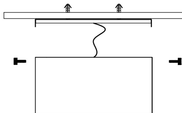
3. Posicionar a luminária fixando a mesma na travessa com os parafusos manipulados.
