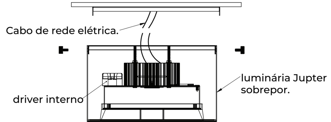
**2. conecte os cabos na rede elétrica.**
