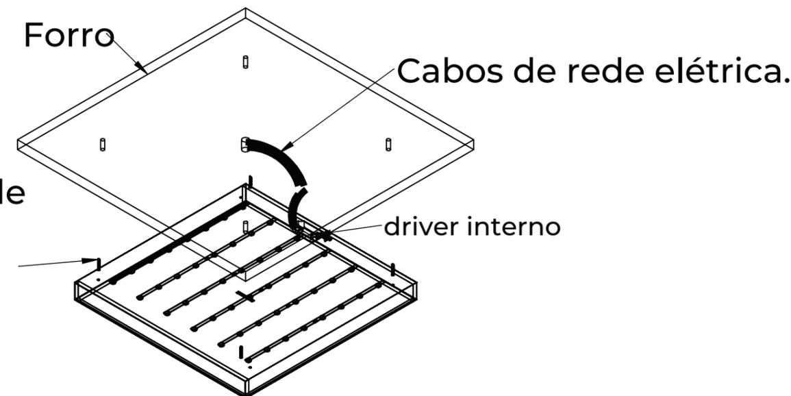
2. Conecte os fios do driver na rede e fixe a luminária com parafusos.
