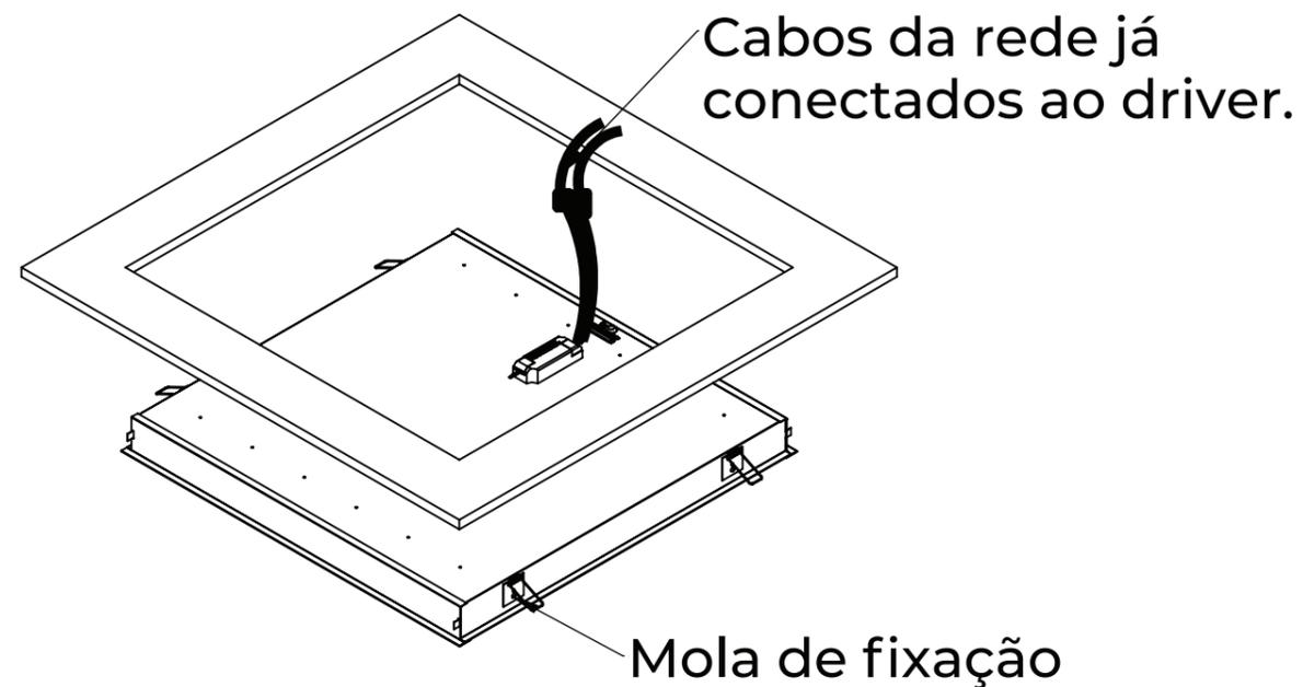
3. Suspenda a luminária ajustando as molas de fixação para encaixe no nicho.
