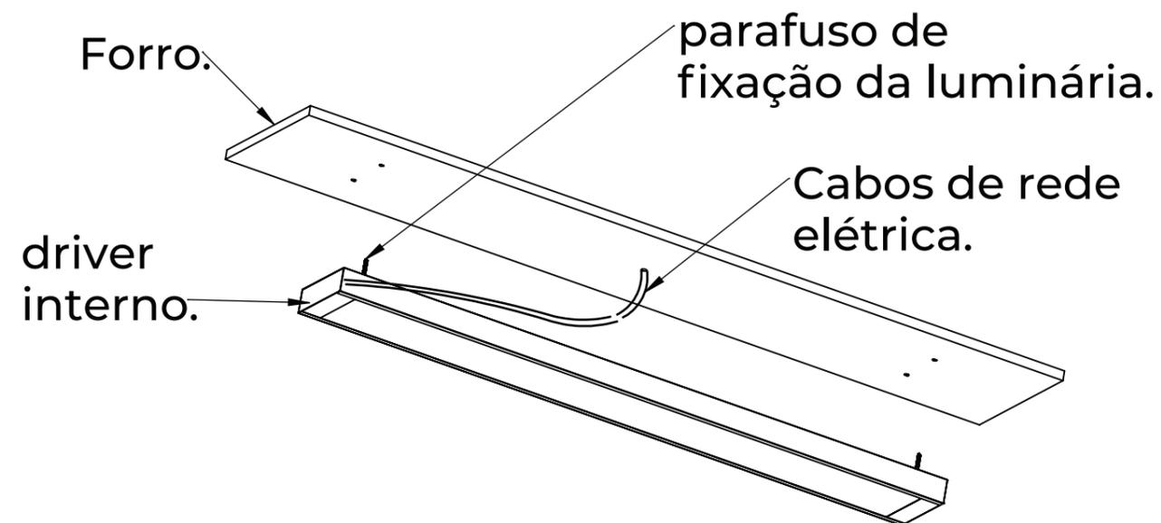
2. Conecte os fios do driver na rede e fixe a luminária com parafusos.
