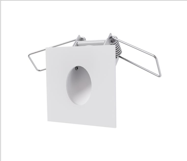
Luminária quadrada, 4W 4000K IRC>80. Corpo em alumínio. Acabamento Preta. Controle óptico principal através de refletor fecho assimétrico. Luminária grau de proteção IP-20. Driver corrente constante Liga/Desliga Tensão de trabalho 127V ou 220V.
