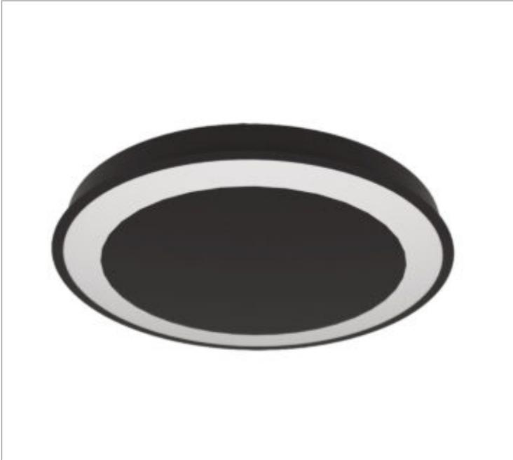
Luminária circular de embutir em forro de gesso, 100W 3000K IRC>80. Corpo em alumínio. Acabamento Branca, Preta ou Especial. Controle óptico principal através de difusor em acrílico translúcido. Luminária grau de proteção IP-20. Driver corrente constante Liga/Desliga, Triac, 1-10V ou Dali (consultar condições). Tensão de trabalho 220V ou Bivolt.
