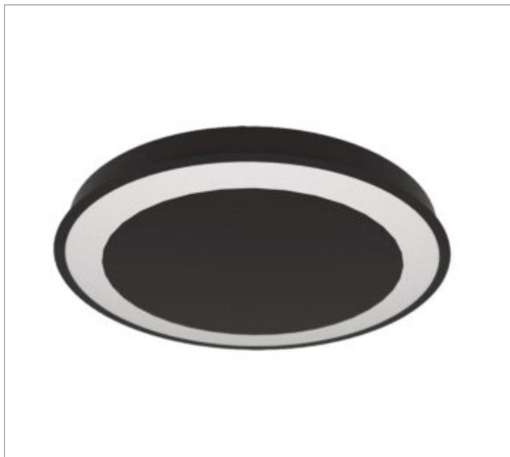
Luminária circular de embutir em forro de gesso, 60W 4000K IRC>80. Corpo em alumínio. Acabamento Branca, Preta ou Especial. Controle óptico principal através de difusor em acrílico translúcido. Luminária grau de proteção IP-20. Driver corrente constante Liga/Desliga, Triac, 1-10V ou Dali (consultar condições). Tensão de trabalho 220V ou Bivolt.
