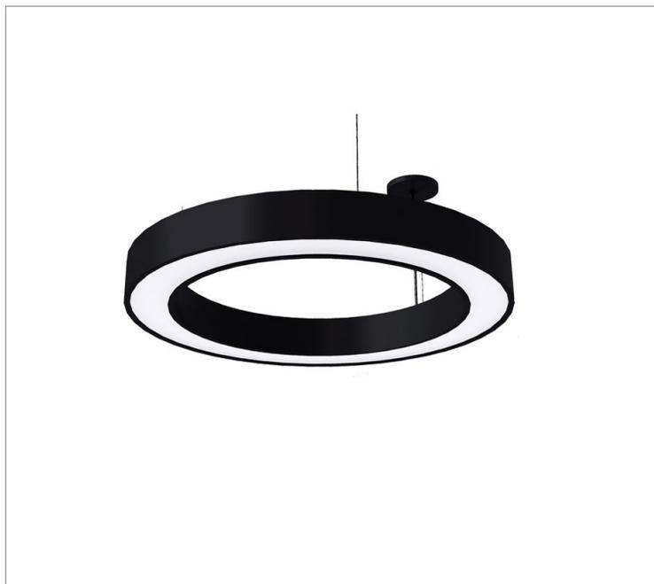
Luminária circular pendente iluminação direta, 60W 4000K IRC>80. Corpo em alumínio. Acabamento Branca, Preta ou Especial. Controle óptico principal através de difusor em acrílico translúcido. Luminária grau de proteção IP-20. Driver corrente constante Liga/Desliga, Triac, 1-10V ou Dali (consultar condições). Tensão de trabalho 220V ou Bivolt.
