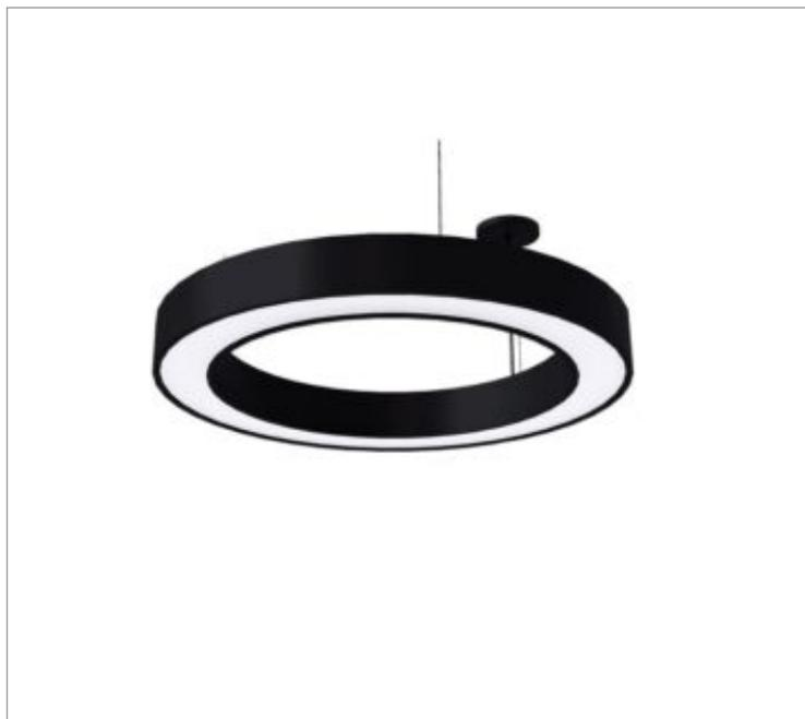
Luminária circular pendente iluminação direta, 60W 5000K IRC>80. Corpo em alumínio. Acabamento Branca, Preta ou Especial. Controle óptico principal através de difusor em acrílico translúcido. Luminária grau de proteção IP-20. Driver corrente constante Liga/Desliga, Triac, 1-10V ou Dali (consultar condições). Tensão de trabalho 220V ou Bivolt.
