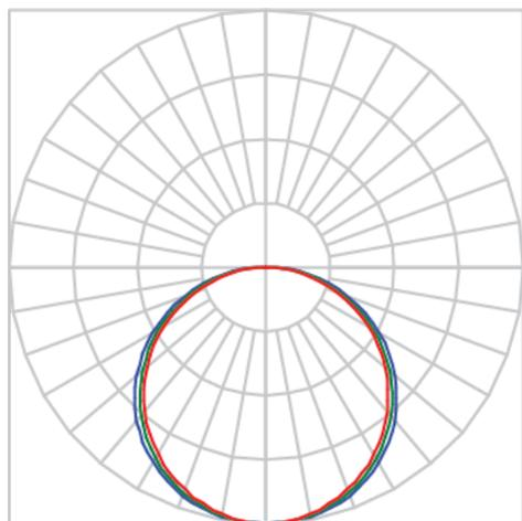
Luminária circular de sobrepор, 20W 5000K IRC>80. Corpo em alumínio. Acabamento Branca, Preta ou Especial. Controle óptico principal através de difusor em acrílico translúcido. Luminária grau de proteção IP-20. Driver corrente constante Liga/Desliga, Triac, 1-10V ou Dali (consultar condições). Tensão de trabalho 220V ou Bivolt.
