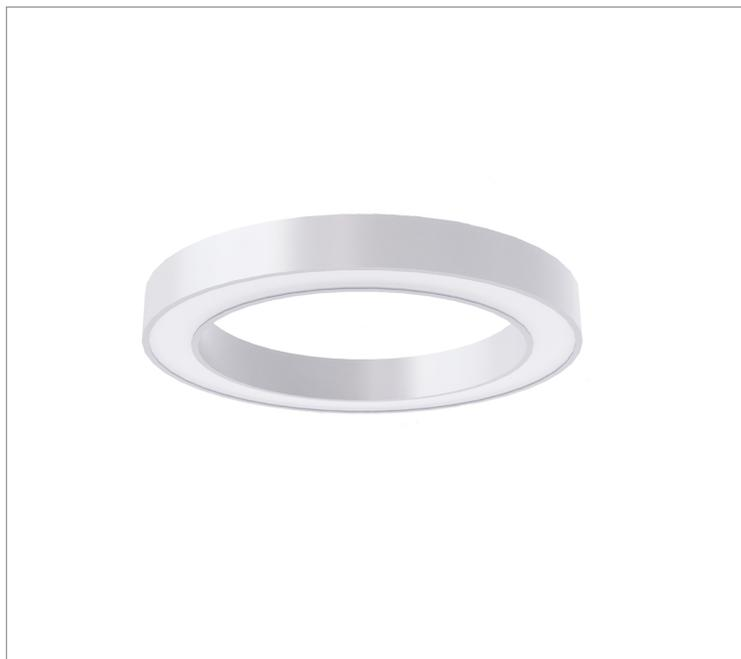
Luminária circular de sobrepор, 40W 2700K IRC>80. Corpo em alumínio. Acabamento Branca, Preta ou Especial. Controle óptico principal através de difusor em acrílico translúcido. Luminária grau de proteção IP-20. Driver corrente constante Liga/Desliga, Triac, 1-10V ou Dali (consultar condições). Tensão de trabalho 220V ou Bivolt.
