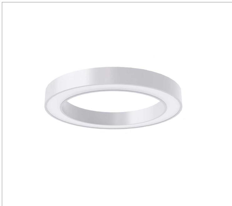
Luminária circular de sobrepôr, 60W 3000K IRC>80. Corpo em alumínio. Acabamento Branca, Preta ou Especial. Controle óptico principal através de difusor em acrílico translúcido. Luminária grau de proteção IP-20. Driver corrente constante Liga/Desliga, Triac, 1-10V ou Dali (consultar condições). Tensão de trabalho 220V ou Bivolt.
