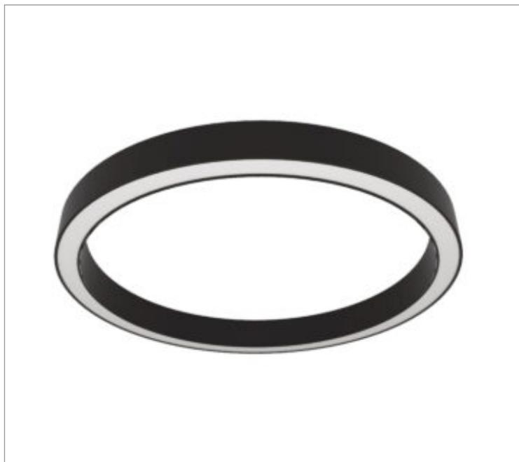
Luminária circular de sobrepор, 60W 2700K IRC>80. Corpo em alumínio. Acabamento Branca, Preta ou Especial. Controle óptico principal através de difusor em acrílico translúcido. Luminária grau de proteção IP-20. Driver corrente constante Liga/Desliga, Triac, 1-10V ou Dali (consultar condições). Tensão de trabalho 220V ou Bivolt.
