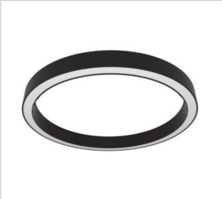
Luminária circular de sobreporthat is a circular, ring-shaped luminaire with a translucent acrylic diffuser. 80W 2700K IRC>95. Corpo em alumínio. Acabamento Branca, Preta ou Especial. Controle óptico principal através de difusor em acrílico translúcido. Luminária grau de proteção IP-20. Driver corrente constante Liga/Desliga, Triac, 1-10V ou Dali (consultar condições). Tensão de trabalho 220V ou Bivolt.
