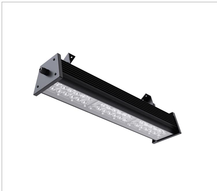
Projektor, 100W 4000K IRC70. Corpo em alumínio. Acabamento Branca, Preta ou Especial. Controle óptico principal através de lente fecho 30°. Luminária grau de proteção IP-65. Driver corrente constante Liga/Desliga, Triac, 1-10V ou Dali (consultar condições). Tensão de trabalho 220V ou Bivolt.
