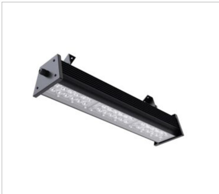
Projektor, 200W 3000K IRC>80. Corpo em alumínio. Acabamento Branca, Preta ou Especial. Controle óptico principal através de lente facho 30°. Luminária grau de proteção IP-54ou65 (consultar condições). Driver corrente constante Liga/Desliga, Triac, 1-10V ou Dali (consultar condições). Tensão de trabalho 220V ou Bivolt.
