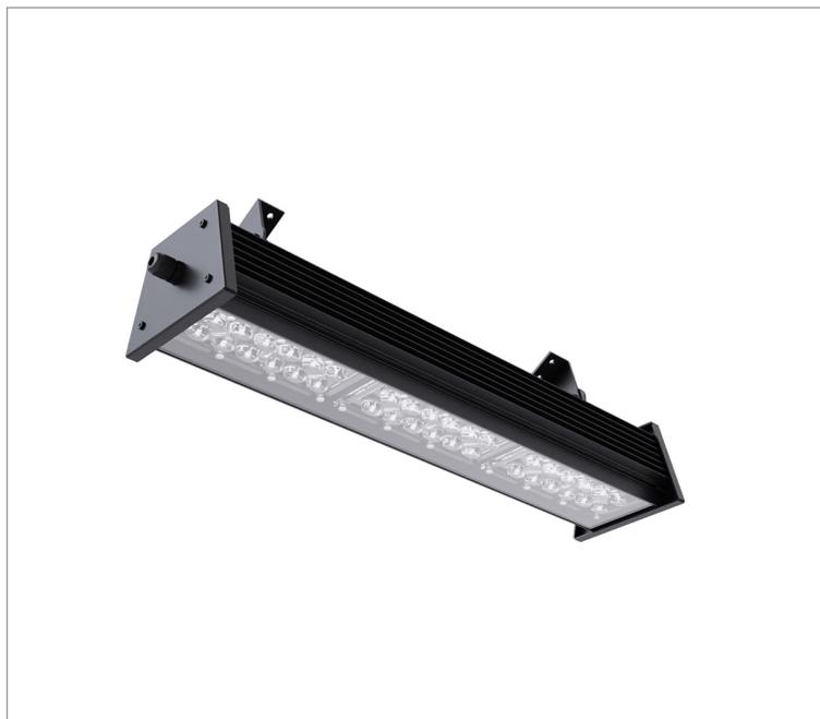
Projeto, 50W 4000K IRC70. Corpo em alumínio. Acabamento Branca, Preta ou Especial. Controle óptico principal através de lente fecho 30°. Luminária grau de proteção IP-65. Driver corrente constante Liga/Desliga, Triac, 1-10V ou Dali (consultar condições). Tensão de trabalho 220V ou Bivolt.
