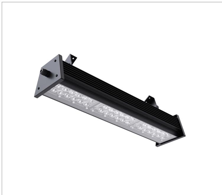
Projektor, 150W 3000K IRC70. Corpo em alumínio. Acabamento Branca, Preta ou Especial. Controle óptico principal através de lente fecho 60°. Luminária grau de proteção IP-65. Driver corrente constante Liga/Desliga, Triac, 1-10V ou Dali (consultar condições). Tensão de trabalho 220V ou Bivolt.
