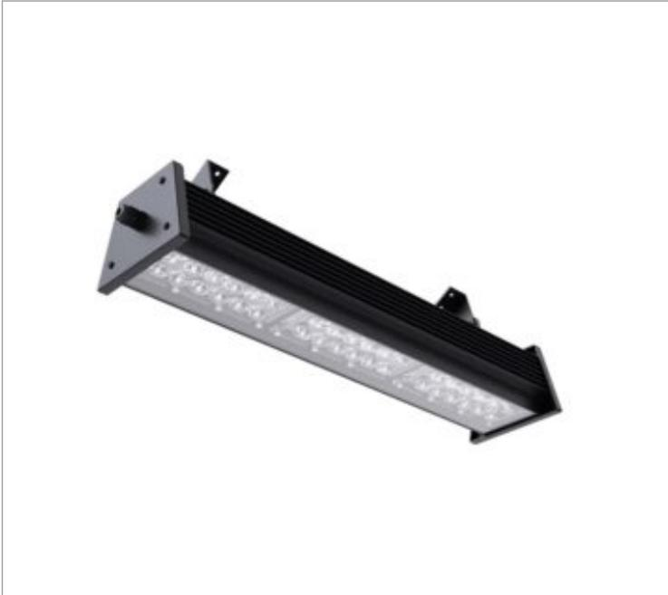
Projektor, 150W 2700K IRC>80. Corpo em alumínio. Acabamento Branca, Preta ou Especial. Controle óptico principal através de lente fecho 90°. Luminária grau de proteção IP-54ou65 (consultar condições). Driver corrente constante Liga/Desliga, Triac, 1-10V ou Dali (consultar condições). Tensão de trabalho 220V ou Bivolt.
