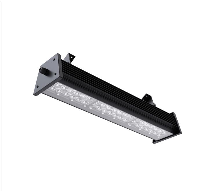
Projektor, 100W 3000K IRC70. Corpo em alumínio. Acabamento Branca, Preta ou Especial. Controle óptico principal através de lente fecho Street. Luminária grau de proteção IP-65. Driver corrente constante Liga/Desliga, Triac, 1-10V ou Dali (consultar condições). Tensão de trabalho 220V ou Bivolt.
