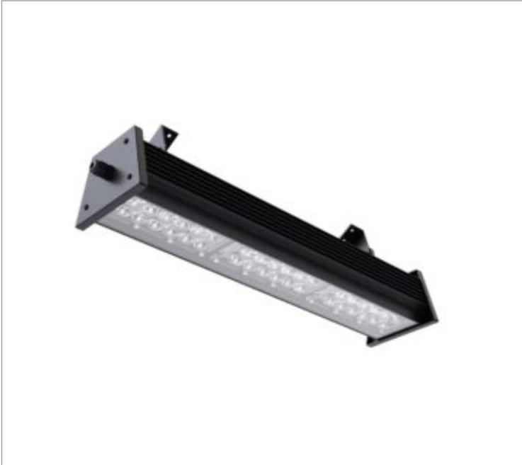
Projektor, 100W 4000K IRC>80. Corpo em alumínio. Acabamento Branca, Preta ou Especial. Controle óptico principal através de lente fecho Street. Luminária grau de proteção IP-54ou65 (consultar condições). Driver corrente constante Liga/Desliga, Triac, 1-10V ou Dali (consultar condições). Tensão de trabalho 220V ou Bivolt.
