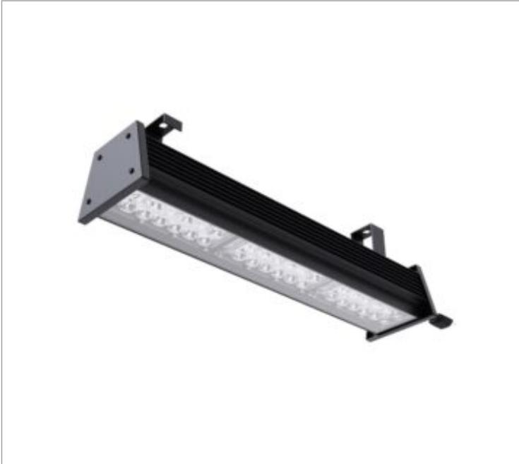
Luminária para perfilado, 150W 3000K IRC>80. Corpo em alumínio. Acabamento Branca, Preta ou Especial. Controle óptico principal através de lente facho 30°. Luminária grau de proteção IP-54ou65 (consultar condições). Driver corrente constante Liga/Desliga, Triac, 1-10V ou Dali (consultar condições). Tensão de trabalho 220V ou Bivolt.
