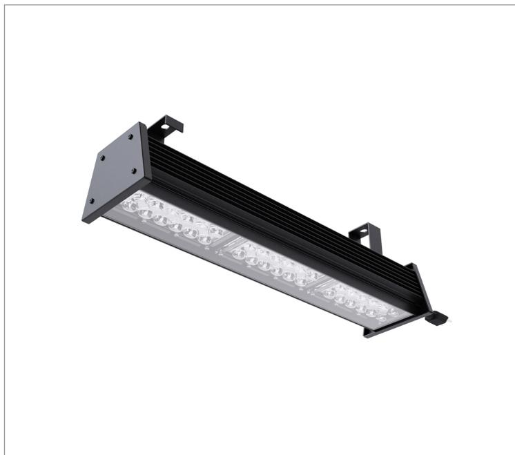
Luminária para perfilado, 50W 5000K IRC70. Corpo em alumínio. Acabamento Branca, Preta ou Especial. Controle óptico principal através de lente facho 30°. Luminária grau de proteção IP-65. Driver corrente constante Liga/Desliga, Triac, 1-10V ou Dali (consultar condições). Tensão de trabalho 220V ou Bivolt.
