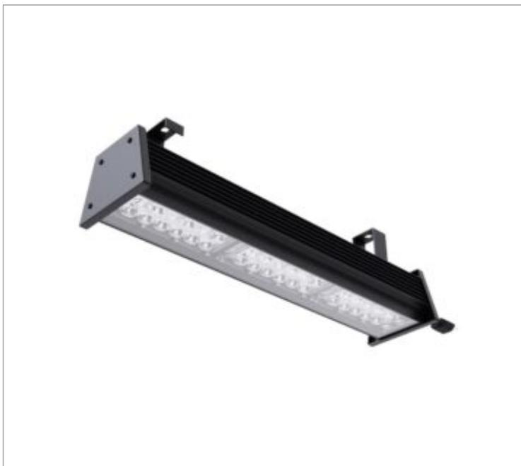
Luminária para perfilado, 50W 2700K IRC>80. Corpo em alumínio. Acabamento Branca, Preta ou Especial. Controle óptico principal através de lente facho 60°. Luminária grau de proteção IP-54ou65 (consultar condições). Driver corrente constante Liga/Desliga, Triac, 1-10V ou Dali (consultar condições). Tensão de trabalho 220V ou Bivolt.
