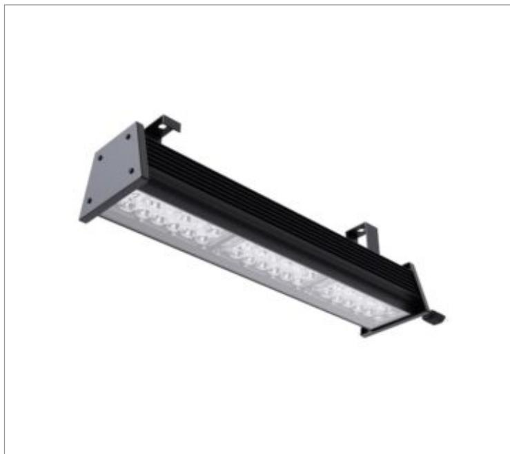
Luminária para perfilado, 150W 5000K IRC>80. Corpo em alumínio. Acabamento Branca, Preta ou Especial. Controle óptico principal através de lente facho 90°. Luminária grau de proteção IP-54ou65 (consultar condições). Driver corrente constante Liga/Desliga, Triac, 1-10V ou Dali (consultar condições). Tensão de trabalho 220V ou Bivolt.
