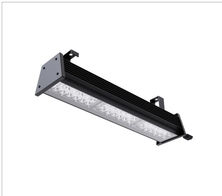
Luminária para perfilado, 200W 4000K IRC70. Corpo em alumínio. Acabamento Branca, Preta ou Especial. Controle óptico principal através de lente facho 90°. Luminária grau de proteção IP-65. Driver corrente constante Liga/Desliga, Triac, 1-10V ou Dali (consultar condições). Tensão de trabalho 220V ou Bivolt.
