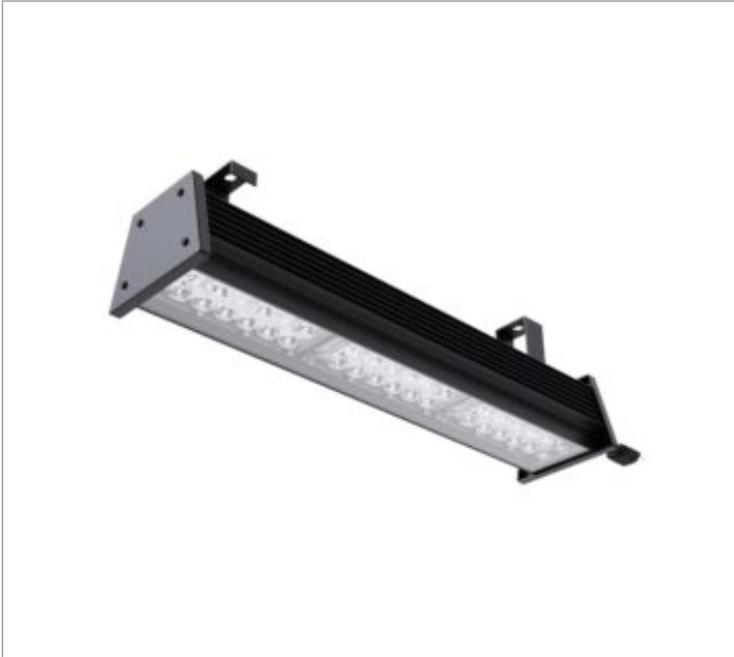
Luminária para perfilado, 150W 5000K IRC>80. Corpo em alumínio. Acabamento Branca, Preta ou Especial. Controle óptico principal através de lente facho Street. Luminária grau de proteção IP-54ou65 (consultar condições). Driver corrente constante Liga/Desliga, Triac, 1-10V ou Dali (consultar condições). Tensão de trabalho 220V ou Bivolt.
