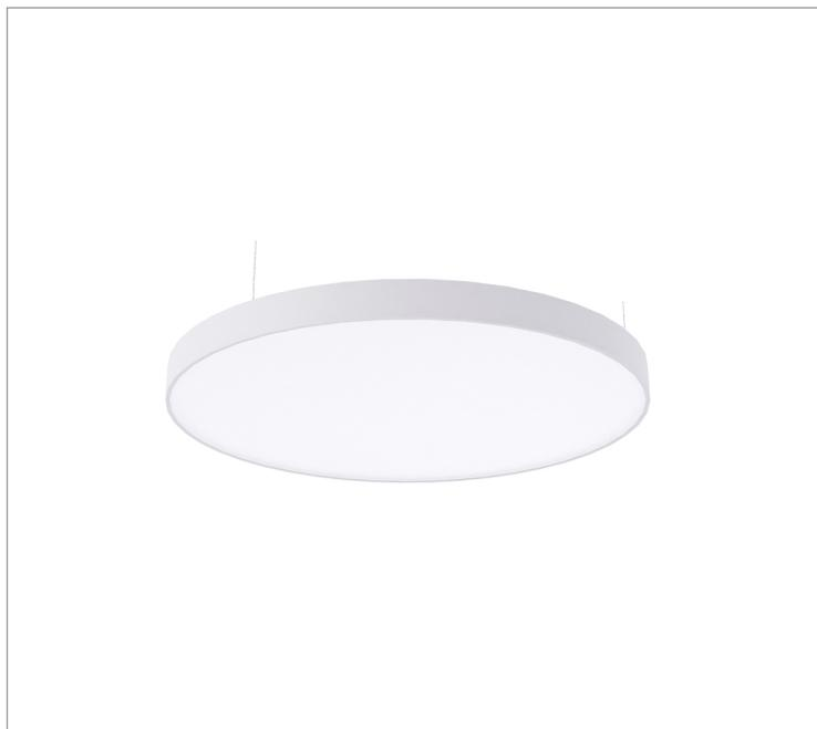
Luminária circular pendente iluminação direta, 20W 3000K IRC>80. Corpo em alumínio. Acabamento Branca, Preta ou Especial. Controle óptico principal através de difusor em acrílico translúcido. Luminária grau de proteção IP-20. Driver corrente constante Liga/Desliga, Triac, 1-10V ou Dali (consultar condições). Tensão de trabalho 220V ou Bivolt.
