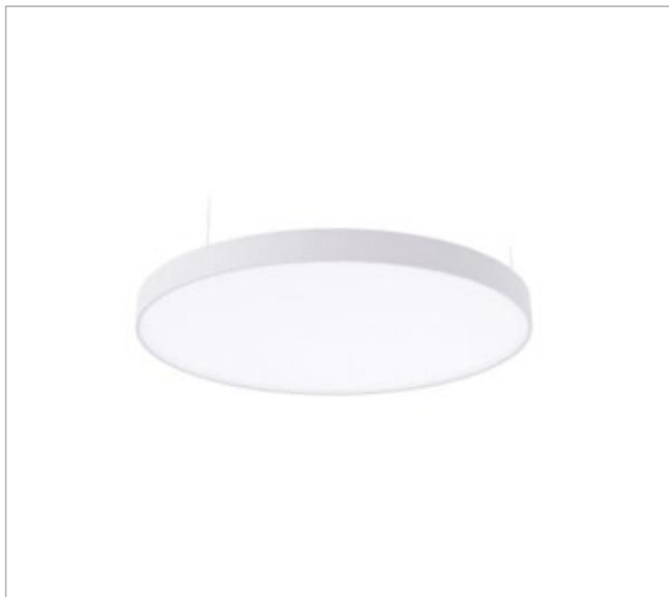
Luminária circular pendente iluminação direta, 80W 4000K IRC>80. Corpo em alumínio. Acabamento Branca, Preta ou Especial. Controle óptico principal através de difusor em acrílico translúcido. Luminária grau de proteção IP-20. Driver corrente constante Liga/Desliga, Triac, 1-10V ou Dali (consultar condições). Tensão de trabalho 220V ou Bivolt.
