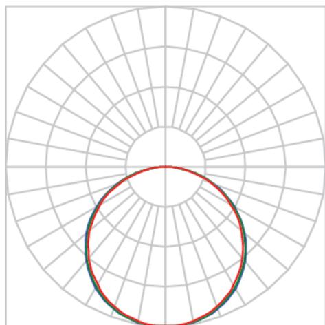
Luminária circular de sobrepor, 100W 4000K IRC>80. Corpo em alumínio. Acabamento Branca, Preta ou Especial. Controle óptico principal através de difusor em acrílico translúcido. Luminária grau de proteção IP-20. Driver corrente constante Liga/Desliga, Triac, 1-10V ou Dali (consultar condições). Tensão de trabalho 220V ou Bivolt.
