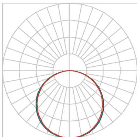
Luminária circular de sobrepor, 60W 2700K IRC>80. Corpo em alumínio. Acabamento Branca, Preta ou Especial. Controle óptico principal através de difusor em acrílico translúcido. Luminária grau de proteção IP-20. Driver corrente constante Liga/Desliga, Triac, 1-10V ou Dali (consultar condições). Tensão de trabalho 220V ou Bivolt.
