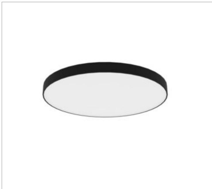
Luminária circular de sobrepor, 60W 4000K IRC>95. Corpo em alumínio. Acabamento Branca, Preta ou Especial. Controle óptico principal através de difusor em acrílico translúcido. Luminária grau de proteção IP-20. Driver corrente constante Liga/Desliga, Triac, 1-10V ou Dali (consultar condições). Tensão de trabalho 220V ou Bivolt.
