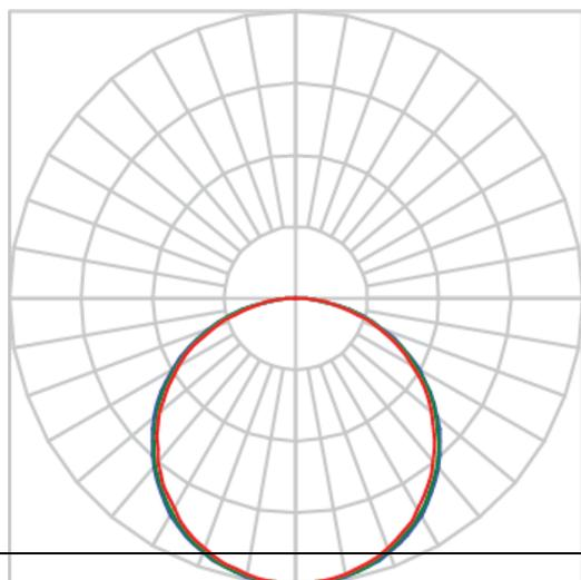
Luminária circular de sobrepor, 60W 3000K IRC>80. Corpo em alumínio. Acabamento Branca, Preta ou Especial. Controle óptico principal através de difusor em acrílico translúcido. Luminária grau de proteção IP-20. Driver corrente constante Liga/Desliga, Triac, 1-10V ou Dali (consultar condições). Tensão de trabalho 220V ou Bivolt.
