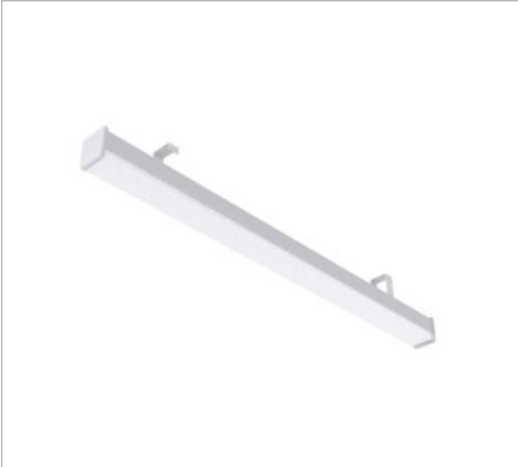
Luminária retangular para perfilado, 20W 3000K IRC>80. Corpo em alumínio. Acabamento Branca, Preta ou Especial. Controle óptico principal através de difusor em acrílico translúcido. Luminária grau de proteção IP-54ou65 (consultar condições). Driver corrente constante Liga/Desliga, Triac, 1-10V ou Dali (consultar condições). Tensão de trabalho 220V ou Bivolt.
