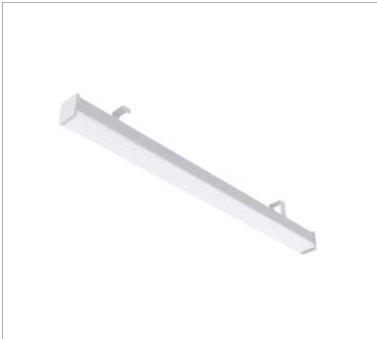
Luminária retangular para perfilado, 20W 4000K IRC>80. Corpo em alumínio. Acabamento Branca, Preta ou Especial. Controle óptico principal através de difusor em acrílico translúcido. Luminária grau de proteção IP-54ou65 (consultar condições). Driver corrente constante Liga/Desliga, Triac, 1-10V ou Dali (consultar condições). Tensão de trabalho 220V ou Bivolt.
