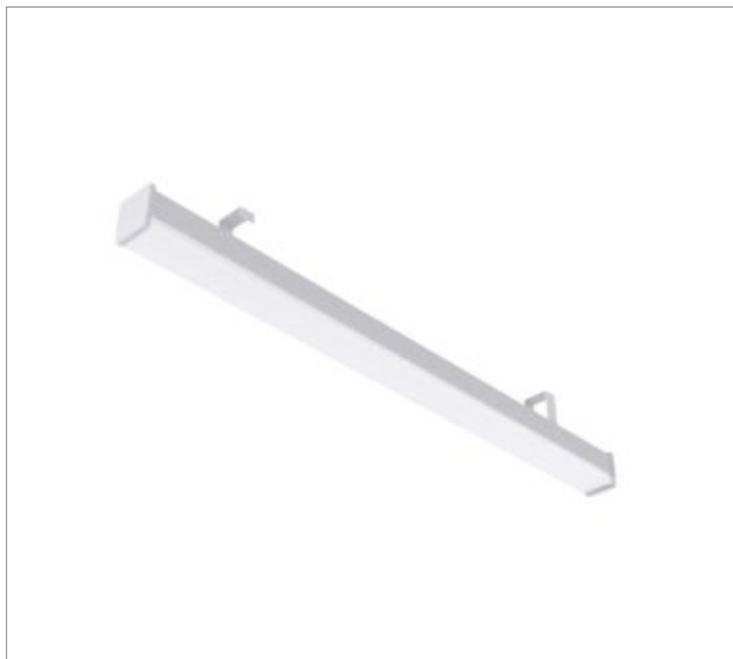
Luminária retangular para perfilado, 37W 5000K IRC>95. Corpo em alumínio. Acabamento Branca, Preta ou Especial. Controle óptico principal através de difusor em acrílico translúcido. Luminária grau de proteção IP-54ou65 (consultar condições). Driver corrente constante Liga/Desliga, Triac, 1-10V ou Dali (consultar condições). Tensão de trabalho 220V ou Bivolt.
