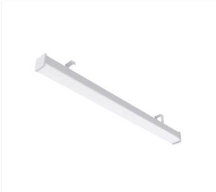
Luminária retangular para perfilado, 54W 2700K IRC>80. Corpo em alumínio. Acabamento Branca, Preta ou Especial. Controle óptico principal através de difusor em acrílico translúcido. Luminária grau de proteção IP-20. Driver corrente constante Liga/Desliga, Triac, 1-10V ou Dali (consultar condições). Tensão de trabalho 220V ou Bivolt.
