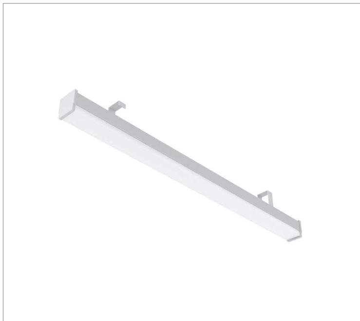
Luminária retangular para perfilado, 54W 3000K IRC>80. Corpo em alumínio. Acabamento Branca, Preta ou Especial. Controle óptico principal através de difusor em acrílico translúcido. Luminária grau de proteção IP-40. Driver corrente constante Liga/Desliga, Triac, 1-10V ou Dali (consultar condições). Tensão de trabalho 220V ou Bivolt.
