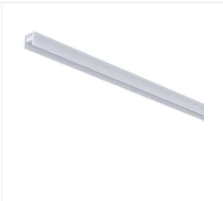
Luminária linear de embutir em forro de gesso, 15Wm 2700K IRC>95. Corpo em alumínio. Acabamento Branca, Preta ou Especial. Controle óptico principal através de fecho difuso. Luminária grau de proteção IP-20ou65 (consultar condições). Driver corrente constante Liga/Desliga, Triac, 1-10V ou Dali (consultar condições). Tensão de trabalho 220V ou Bivolt.
