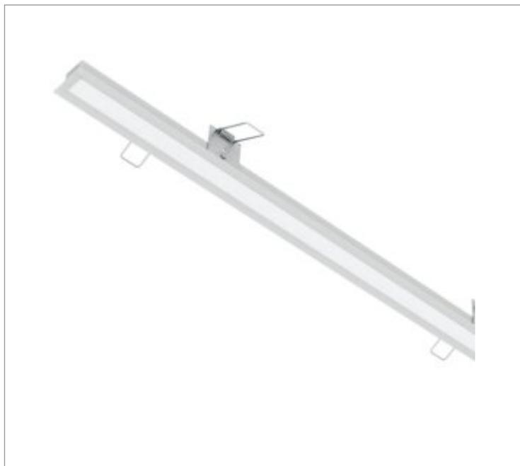
Luminária linear de embutir em forro de gesso, 15Wm 3000K IRC>80. Corpo em alumínio. Acabamento Branca, Preta ou Especial. Controle óptico principal através de difusor extrudado. Luminária grau de proteção IP-20ou65 (consultar condições). Driver corrente constante Liga/Desliga, Triac, 1-10V ou Dali (consultar condições). Tensão de trabalho 220V ou Bivolt.
