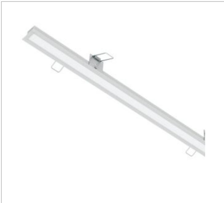
Luminária linear de embutir em forro de gesso, 25Wm 5000K IRC>80. Corpo em alumínio. Acabamento Branca, Preta ou Especial. Controle óptico principal através de difusor em poliestireno translúcido. Luminária grau de proteção IP-20ou65 (consultar condições). Driver corrente constante Liga/Desliga, Triac, 1-10V ou Dali (consultar condições). Tensão de trabalho 220V ou Bivolt.
