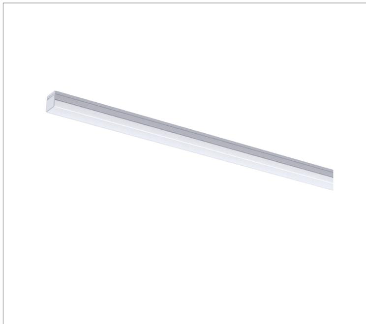
Luminária linear de sobrepor, 15Wm 3000K IRC>80. Corpo em alumínio. Acabamento Branca, Preta ou Especial. Controle óptico principal através de fecho difuso. Luminária grau de proteção IP-20. Driver corrente constante Liga/Desliga, Triac, 1-10V ou Dali (consultar condições). Tensão de trabalho 220V ou Bivolt.
