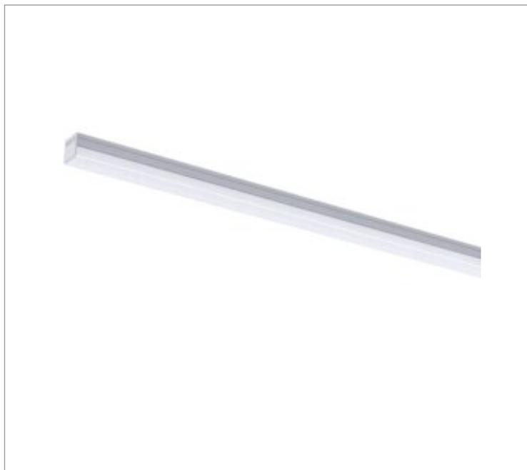
Luminária linear de sobrepor, 15Wm 3000K IRC>95. Corpo em alumínio. Acabamento Branca, Preta ou Especial. Controle óptico principal através de fecho difuso. Luminária grau de proteção IP-20ou65 (consultar condições). Driver corrente constante Liga/Desliga, Triac, 1-10V ou Dali (consultar condições). Tensão de trabalho 220V ou Bivolt.
