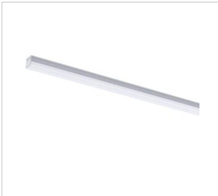
Luminária linear de sobrepor, 25Wm 3000K IRC>95. Corpo em alumínio. Acabamento Branca, Preta ou Especial. Controle óptico principal através de difusor em poliestireno translúcido. Luminária grau de proteção IP-20ou65 (consultar condições). Driver corrente constante Liga/Desliga, Triac, 1-10V ou Dali (consultar condições). Tensão de trabalho 220V ou Bivolt.
