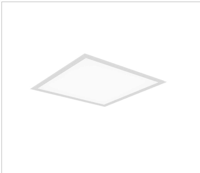
Luminária quadrada de embutir em forro de gesso, 40W 3000K IRC>80. Corpo em alumínio. Acabamento Branca. Controle óptico principal através de fecho difuso. Luminária grau de proteção IP-20. Driver corrente constante Liga/Desliga Tensão de trabalho Bivolt.
